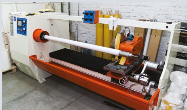
Оборудование для перемотки и резки пленки (вверху) и размотчик двустороннего скотча (внизу). Позволяют нарезать материалы нужных заказчику ширины и метража
